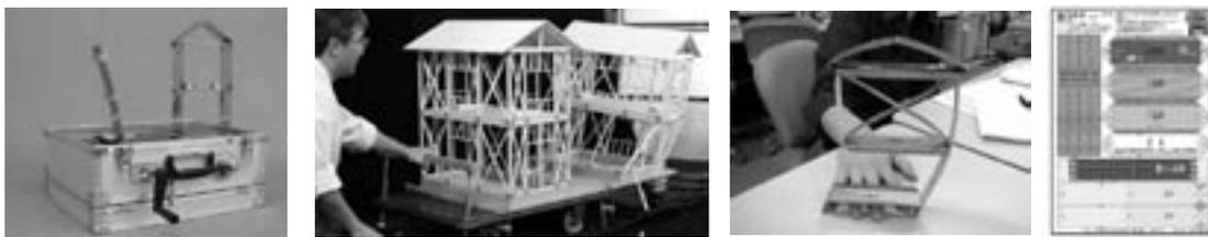
振動教材「手回しぶるる」 「木造ぶるる」実際に倒壊する木造耐震化教材 「紙ぶるる」子供でも簡単工作 ↑ 型紙
